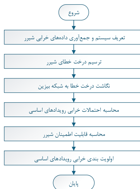
شکل ۳- فلوچارت تبدیل درخت خطا به شبکه بیزین
