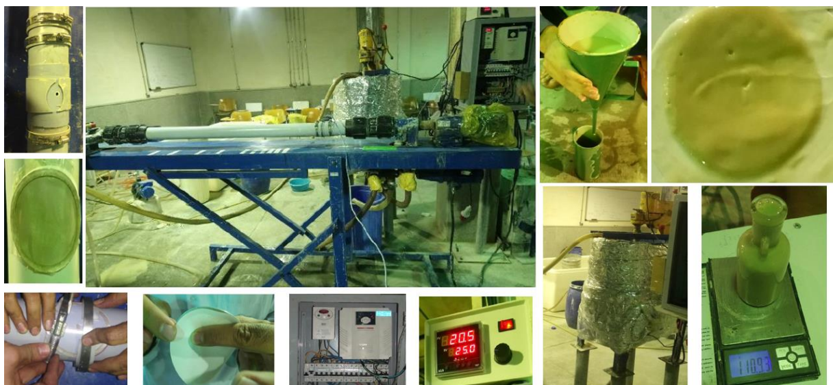
شکل ۳- شمای کلی دستگاه و نحوه آماده سازی آزمایش (محدوده دمایی دستگاه قابل تنظیم تا ۹۰ درجه سانتیگراد، ظرفیت پمپاژ تا ۳۰ لیتر بر دقیقه، جنس فضا از لوله پولیکا، ابعاد دیسک‌های فیلتر مطابق استاندارد استاتیکی و سرعت موتور چرخشی تا ۱۱۰ دور بر دقیقه)
