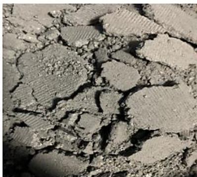
شکل ۲- محصول بدست آمده از HPGR که به صورت کیک درآمده است
