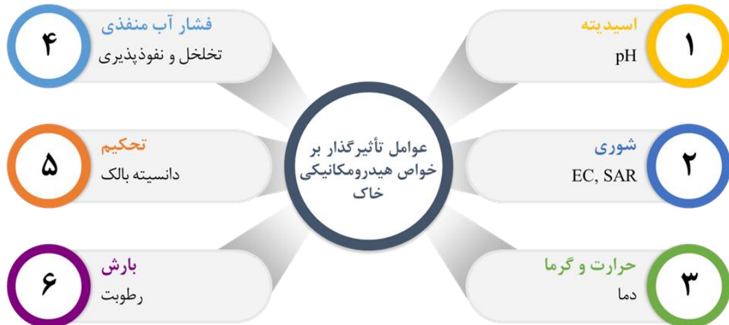
شکل ۳- پارامترهای اثرگذار بر خواص هیدرومکانیکی خاک‌ها
