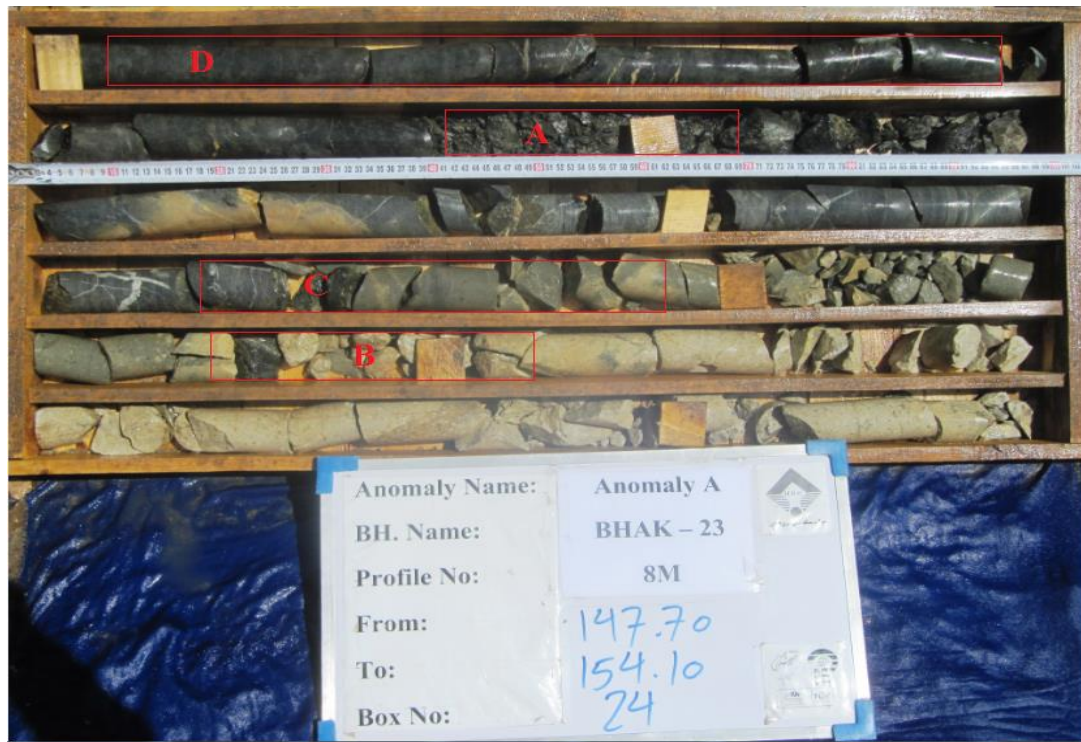
شکل ۳- نمونه‌ای از تصویر مغزه حفاری ارزیابی شده مربوط به فاصله عمقی ۱۴۷/۷۰ تا ۱۵۴/۱۰ متر از گمانه BHAK-23
