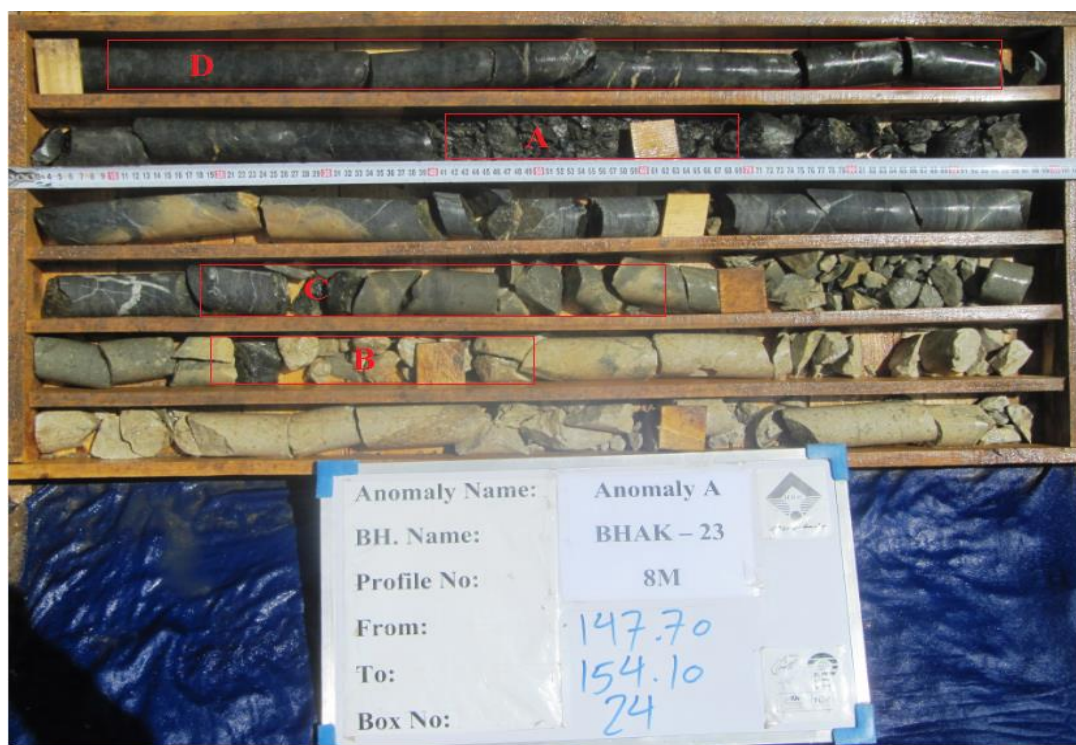
شکل ۳- نمونه‌ای از تصویر مغزه حفاری ارزیابی شده مربوط به فاصله عمقی ۱۴۷/۷۰ تا ۱۵۴/۱۰ متر از گمانه BHAK-23
