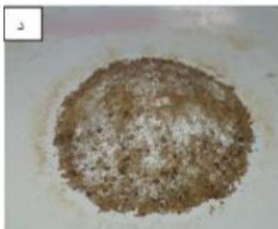
شکل ۱۰- نمایی از نمونه‌های ساخته شده، الف- نمونه بدون دوغاب، ب- نمونه بدون دوغاب در معرض وزش باد، ج- نمونه دوغاب پاشی شده و د- نمونه حاوی دوغاب در معرض وزش باد
