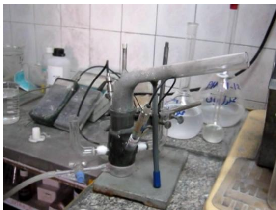
شکل ۱: تصویر و طرح شماتیک سلول میکروفلوتاسیون
