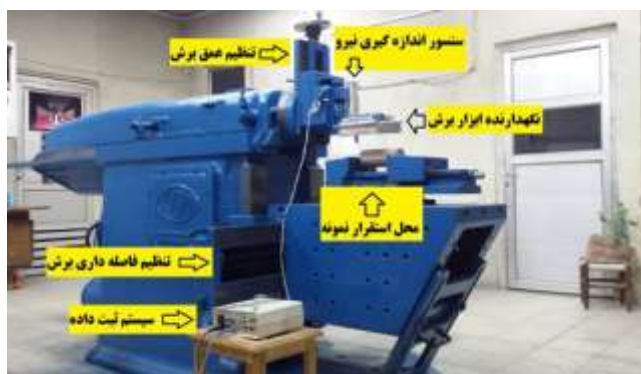
شکل ۵- ماشین آزمون برش خطی کوچک‌مقیاس در دانشگاه تربیت مدرس
