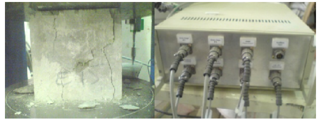
(الف) دیتا لاگر (ب) نمونه مکعبی پس از شکست
