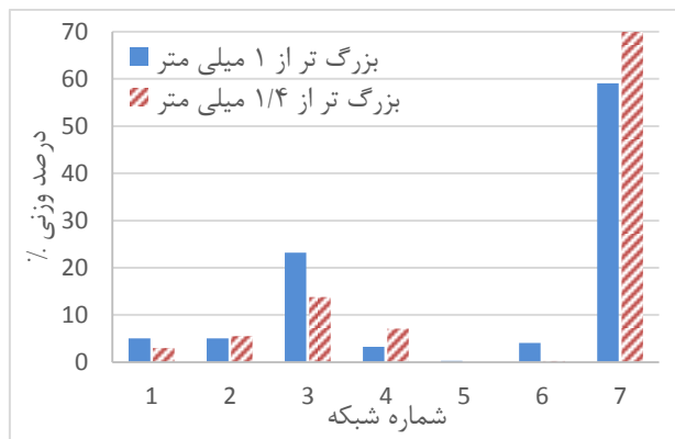
شکل ۱۳: توزیع ذرات بزرگ‌تر از ۱ و ۱/۴ میلی‌متر در خروجی مارپیچ
