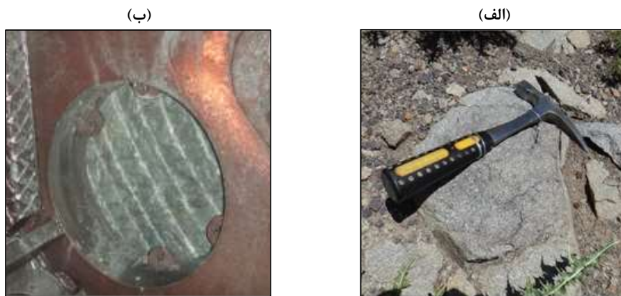
شکل ۵- رخنمونی از توده سنگ آذرین EAT2 (آندزیت) دربرگیرنده تونل کرمان: الف- سطح زمین؛ ب- جبهه کار تونل در ۳+۵۵۰ کیلومتر [۱۹].
