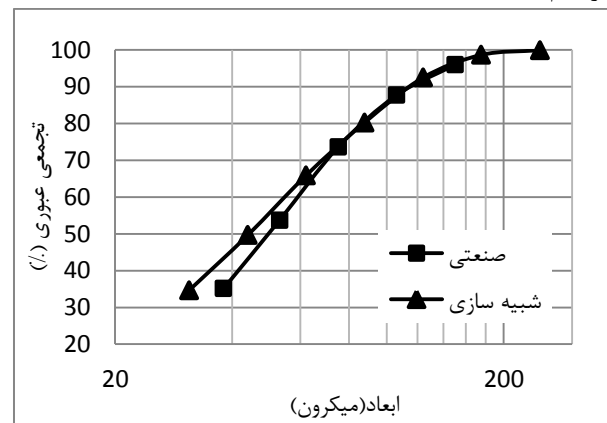
شکل ۵: مقایسه توزیع ابعادی سرریز هیدروسیکلون شبیه سازی شده و واقعی در درصد جامد ۷۰٪
