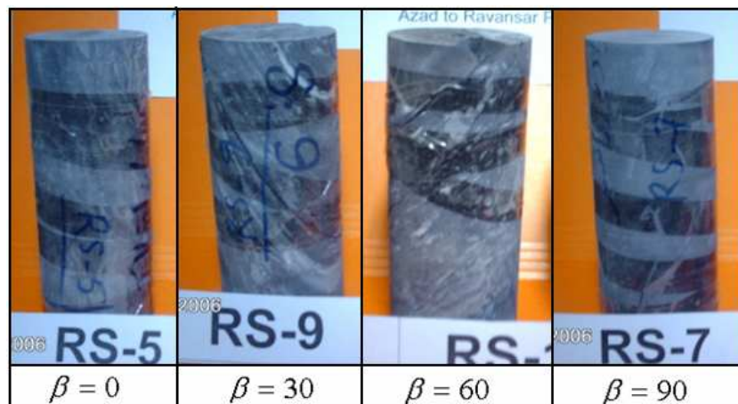
شکل ۳: نمونه‌های مورد آزمایش با زوایای مختلف تورق
