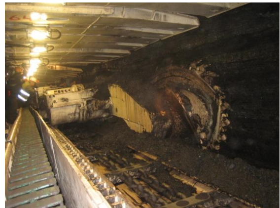
شکل ۱: نمایی از کارگاه جبهه کار طولانی مکانیزه در معدن طبس
