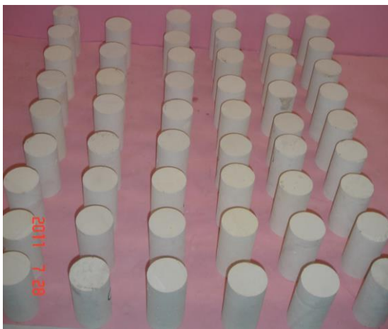
شکل ۱: بخشی از نمونه های آماده سازی شده بر اساس استاندارد انجمن بین المللی مکانیک سنگ (۱۹۷۹)
