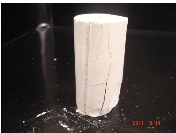
شکل ۸: شکست در بدنه سالم نمونه دارای ناپیوستگی پر شده با جهت یافتگی ۹۰ درجه با حالت افقی
