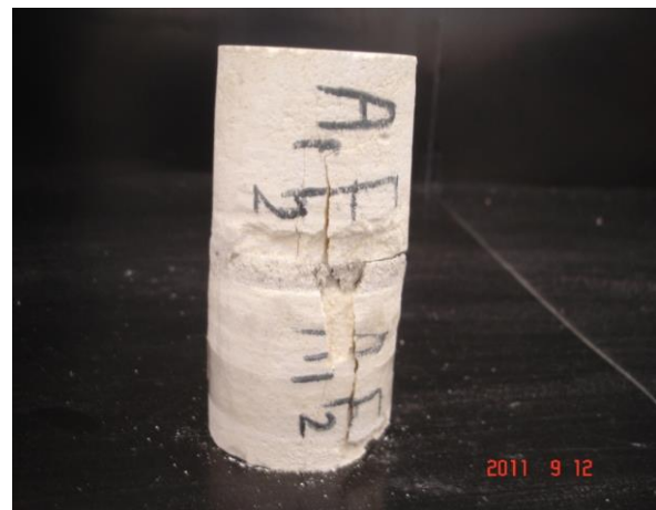
شکل ۴: شکست در بدنه سالم نمونه دارای ناپیوستگی پر شده با جهت یافتگی ۰ درجه نسبت به حالت افقی
