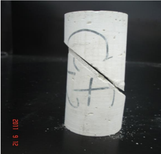
شکل ۶: شکست در صفحه تماس بین دیواره ناپیوستگی و ماده پرکننده دارای مقاومت بیشتر برای جهت یافتگی ۴۵ درجه با حالت افقی
