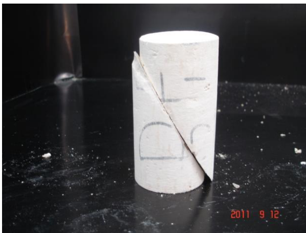
شکل ۷: شکست در صفحه تماس بین دیواره ناپیوستگی و ماده پرکننده دارای مقاومت بیشتر برای جهت یافتگی ۶۰ درجه
