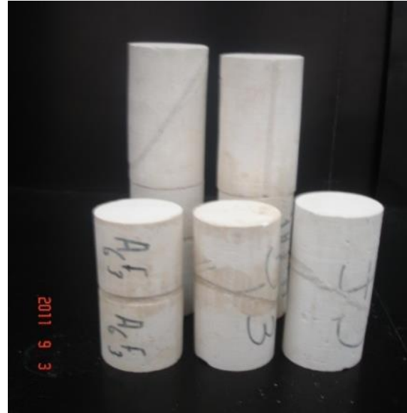
شکل ۳: نمونه های دارای ناپیوستگی با جهت یافتگی مختلف و پر شده از ماده مدل
