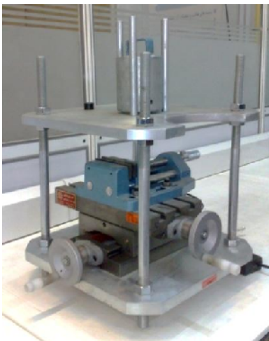
شکل ۱۲: دستگاه تعیین اندیس سایش سرشار طراحی و ساخته شده در آزمایشگاه مهندسی زمین دانشکده مهندسی معدن دانشگاه تهران
