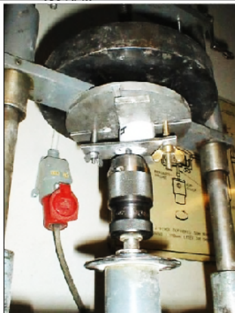
شکل ۸: طرح شماتیک و دستگاه آزمایش چال خوری سیورز - J [۱۹]
