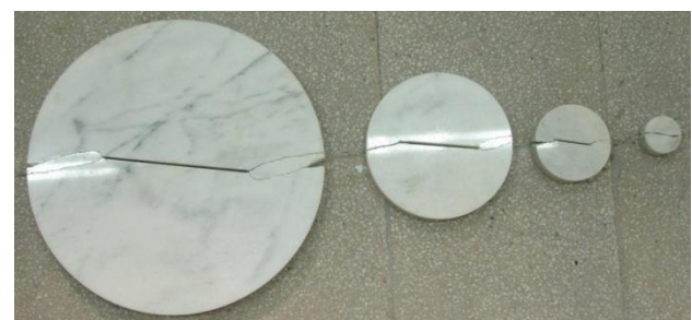
شکل ۳: نمونه‌های CCCD شکسته شده در حالت بارگذاری مود ترکیبی I/II
