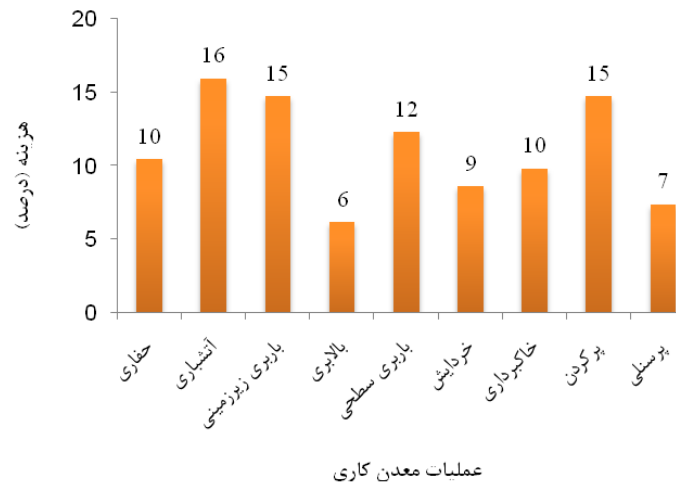
شکل ۴- سهم عملیات معدنکاری در قیمت تمام شده تولید یک تن ماده معدنی [۲۰].
