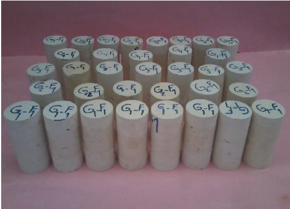
شکل ۴- تعدادی از نمونه‌های آماده‌سازی شده گروه‌های مختلف دارای ناپیوستگی زبر موجدار (R-L) با شیب‌های مختلف تهیه شده از سنگ آهک
