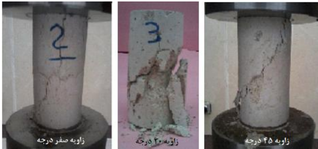
شکل ۱۱- شکست در بدنه سالم نمونه‌های دارای ناپیوستگی زبر دندان‌دار دارای زاویه صفر و ۳۰ درجه و لغزش در امتداد ناپیوستگی زبر دندان‌دار دارای زاویه ۴۵ درجه تحت تنش یک محوری
