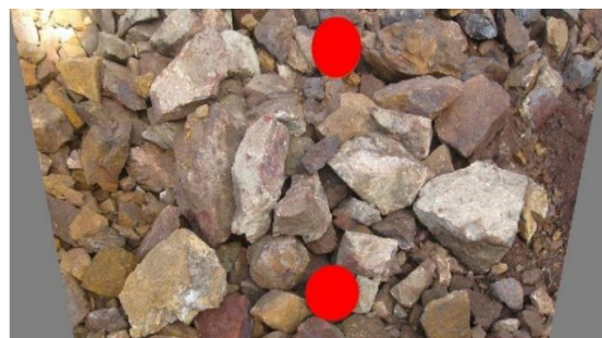
شکل ۱۲- پارامترهای تبدیل هندسی رفع خطای اعوجاج بر روی یک نمونه تصویر توده سنگ خرد شده
