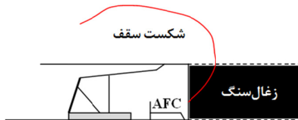
شکل ۱: نمای شماتیک شکست سقف در محدوده کارگاه استخراج
