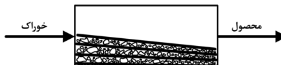
شکل ۲: اثر غربالگری میله‌ها در آسیا
