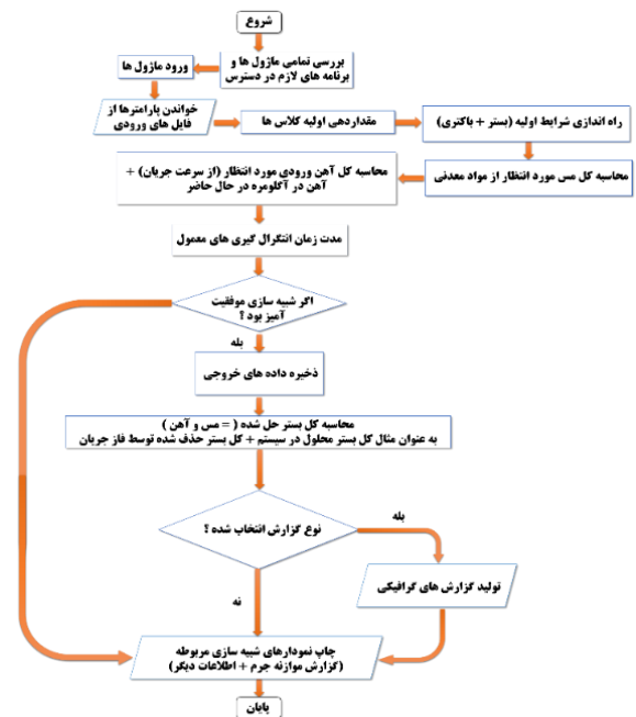
شکل ۲: نمودار برنامه برای انجام محاسبات عددی و حل مدل به همراه موازنه جرم
