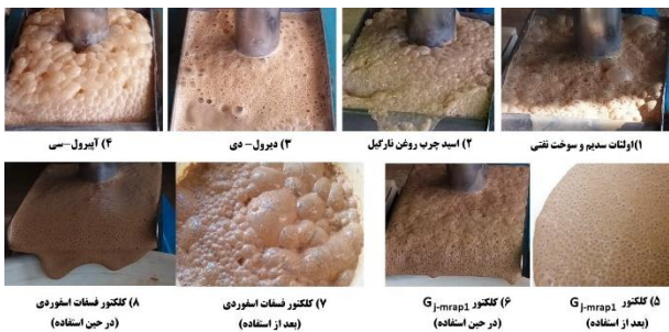
شکل ۱۴- مقایسه پایداری کف حین و بعد از استفاده در فرآیند فلوتاسیون با کلکتورهای مختلف.
