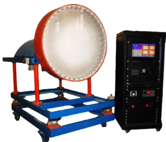
شکل ۲: آسیای آزمایشگاهی با قطر یک متر
