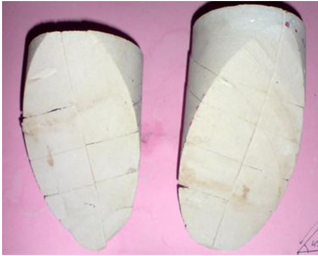
شکل ۱: نمونه دارای سه دسته ناپیوستگی متقاطع و عمود برهم شامل یک دسته قائم، دو دسته ناپیوستگی عمود بر هم دارای زوایای ۳۰ و ۶۰ درجه و در جهت مخالف همدیگر، دسته ناپیوستگی با زاویه ۳۰ درجه با ۴ ناپیوستگی موازی
