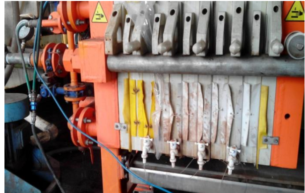
شکل ۲: تصویر دستگاه فیلتر پرس نیمه‌صنعتی
