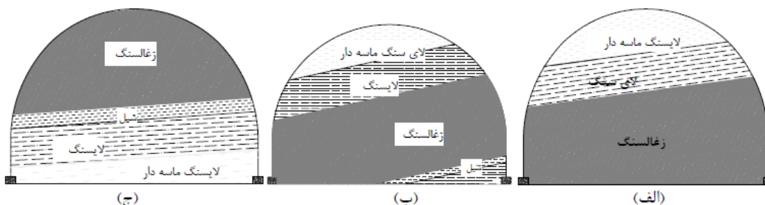
شکل ۳: حالت‌های مختلف سینه کار مختلط در مقاطع مختلف
