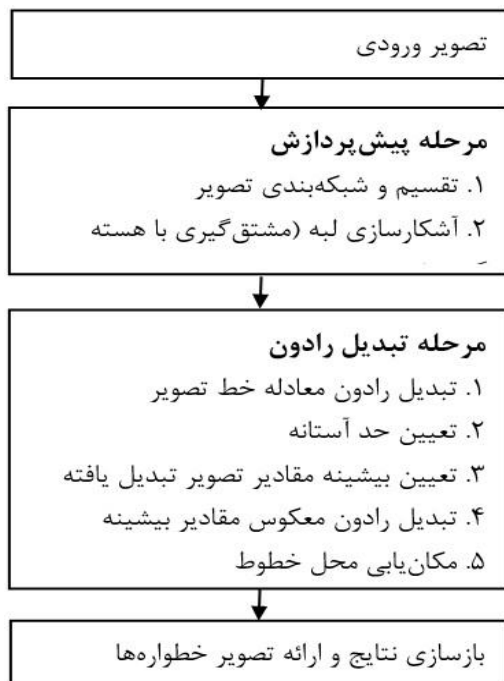
شکل ۳: فلوچارت روش ارائه شده جهت تشخیص خطواره‌های تصویر براساس تبدیل رادون.
