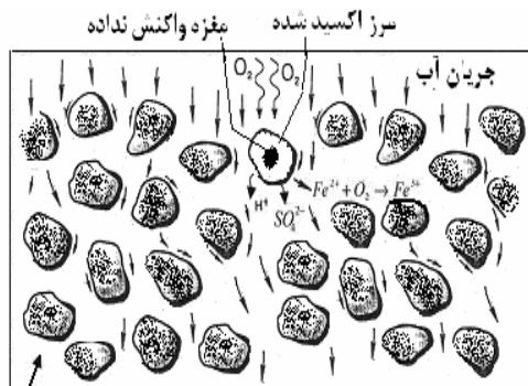
شکل ۱: فرآیند کسید شدن پیریت، تولید زهاب اسیدی معدن و نشست آلاینده‌ها [۸]
