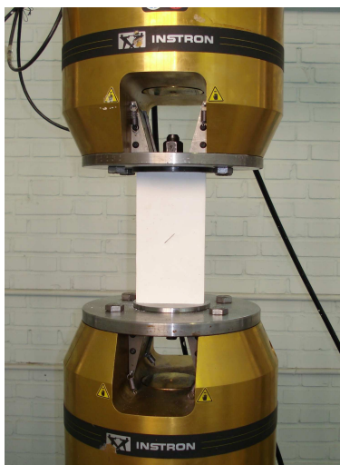
شکل ۱۲: نمونه گچی تحت بارگذاری فشاری تک محوری
