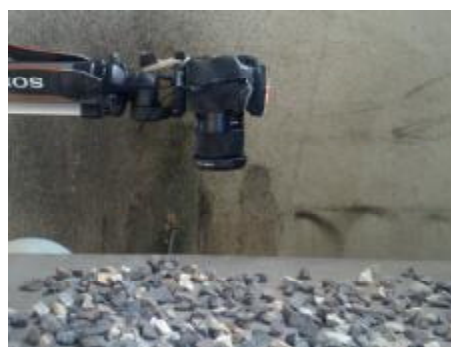
شکل 2. موقعیت دوربین عکاسی در حالت عمود بر سطح نوار
