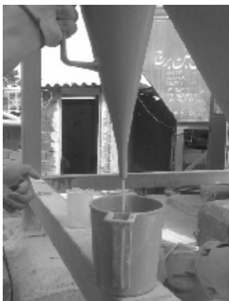
شکل ۴: تعیین مارش دوغاب بنتونیت بوسیله مخروط مارش ۵ میلیمتر
