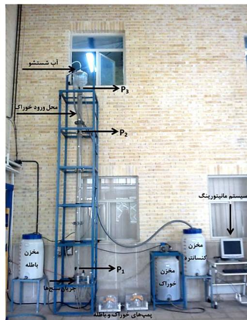
شکل ۱: نمایی از ستون فلوتاسیون آزمایشگاهی مورد استفاده
