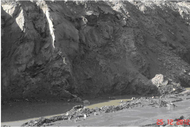
شکل ۲: نمونه‌ای از دیواره پله دارای شیب مایل حاصل از حفر چال-های انفجاری به صورت قائم در معدن سنگ آهن گل گهر
