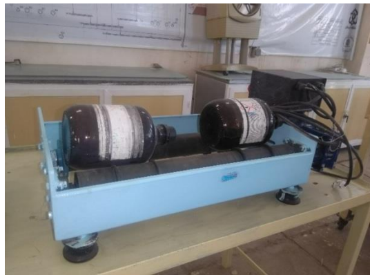
شکل ۴- انجام آزمایش‌های فروشویی (دستگاه بطری غلتان به همراه بطری‌ها)
