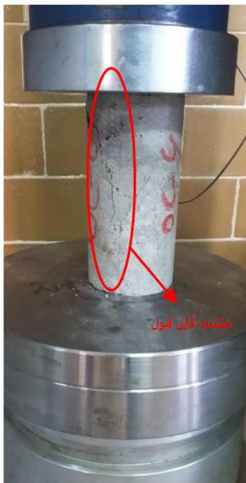
شکل ۵- نمونه بتن برای آزمایش مقاومت فشاری تک‌محوری زیر دستگاه بارگذاری محوری
