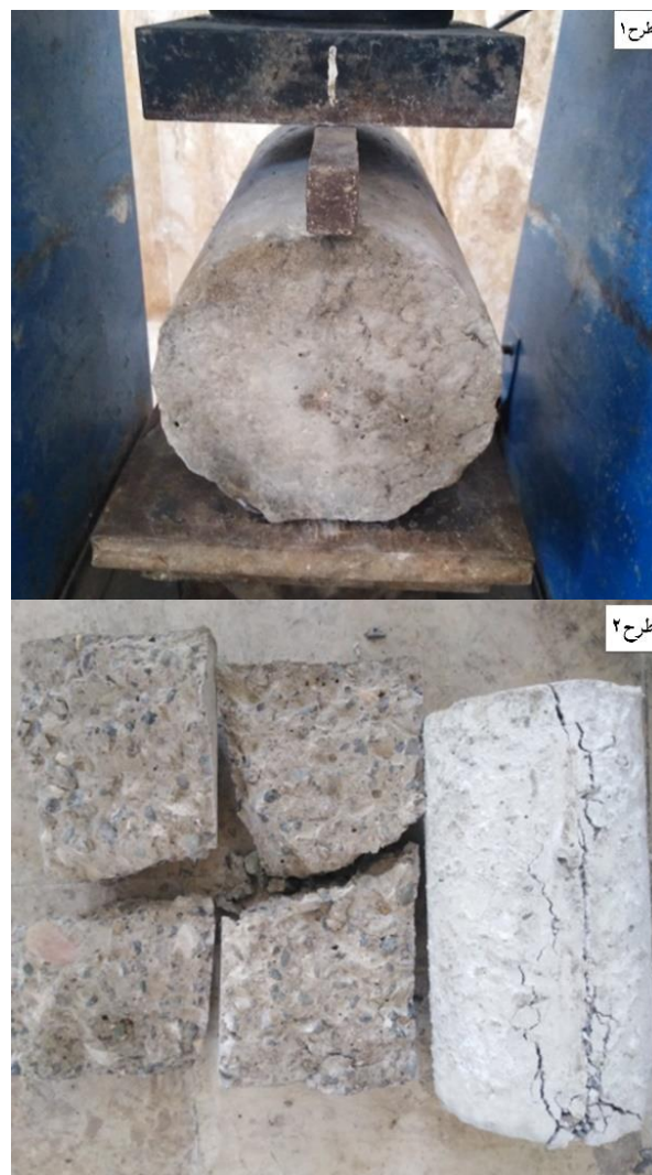
شکل ۲- نمونه بتنی در آزمون مقاومت کششی
