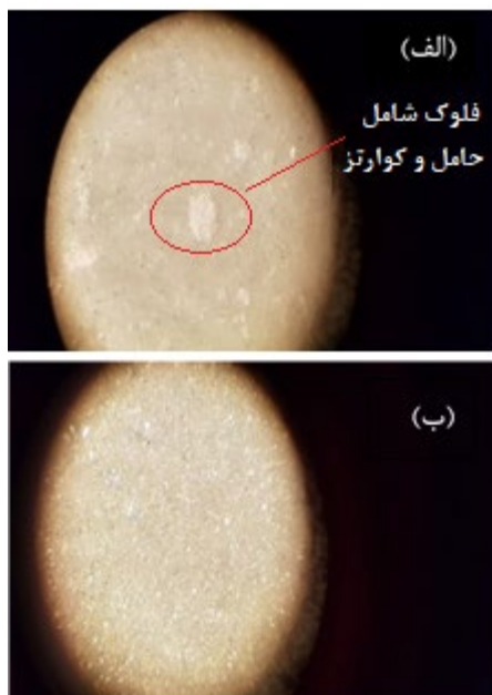
شکل ۳- تصویر گرفته شده از محصولات آزمایش توسط بینوکلار (الف) کنسانتره، (ب) باطله
