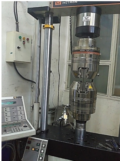
شکل ۴- آزمون‌های کشش با استفاده از دستگاه Instron8502
