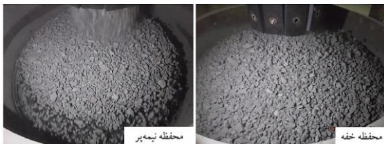
شکل ۱۳- کار سنگ شکن مرحله سوم در حالت خفه و نیمه پر
