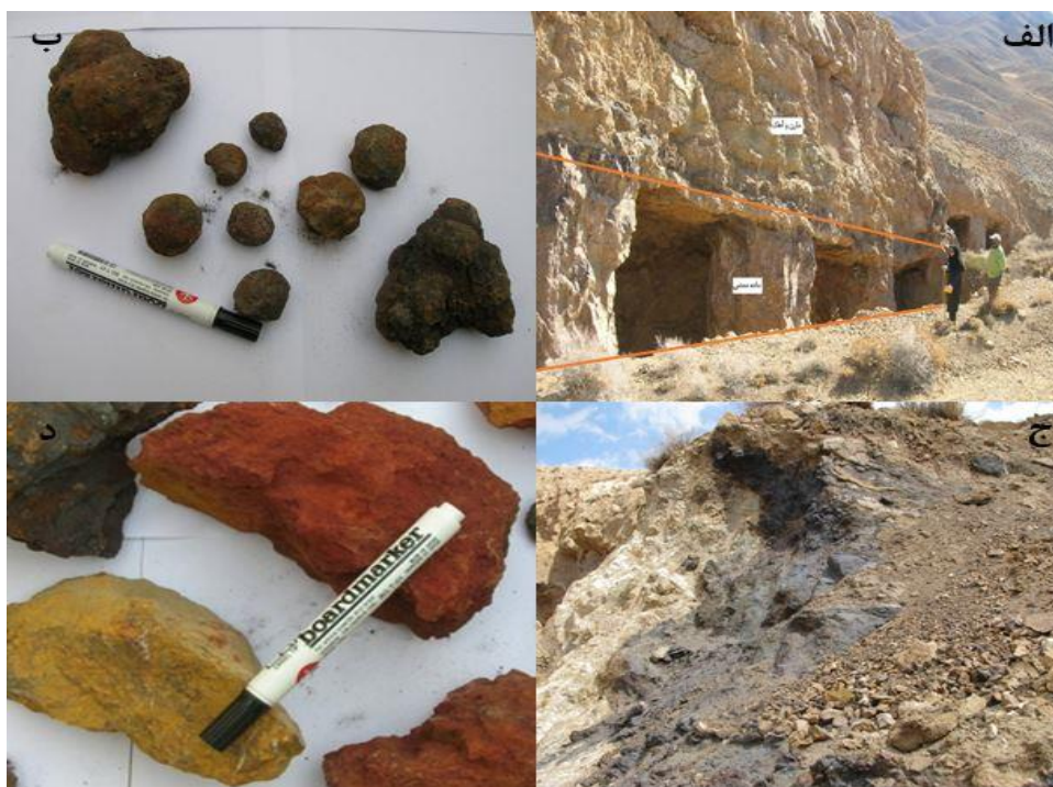
شکل ۲- الف) کانسنگ سخت هماتیت - مگنتیت که به فرم لایه‌ای و هم شیب با واحد رسوبی آهک ماسه‌ای قرار گرفته است. در شکل استخراج اتاق - پایه ماده معدنی نیز مشاهده می‌شود، ب) گرهک‌های هماتیته منفرد و تجمعی، ج) افق سیاه رنگ مربوط به هماتیت‌های نرم میزبان گرهک‌ها که با کنتاکت موجدار به آهک‌های ماسه‌ای اتصال دارد، د) کانسنگ هماتیت اخری و لیمونیت
