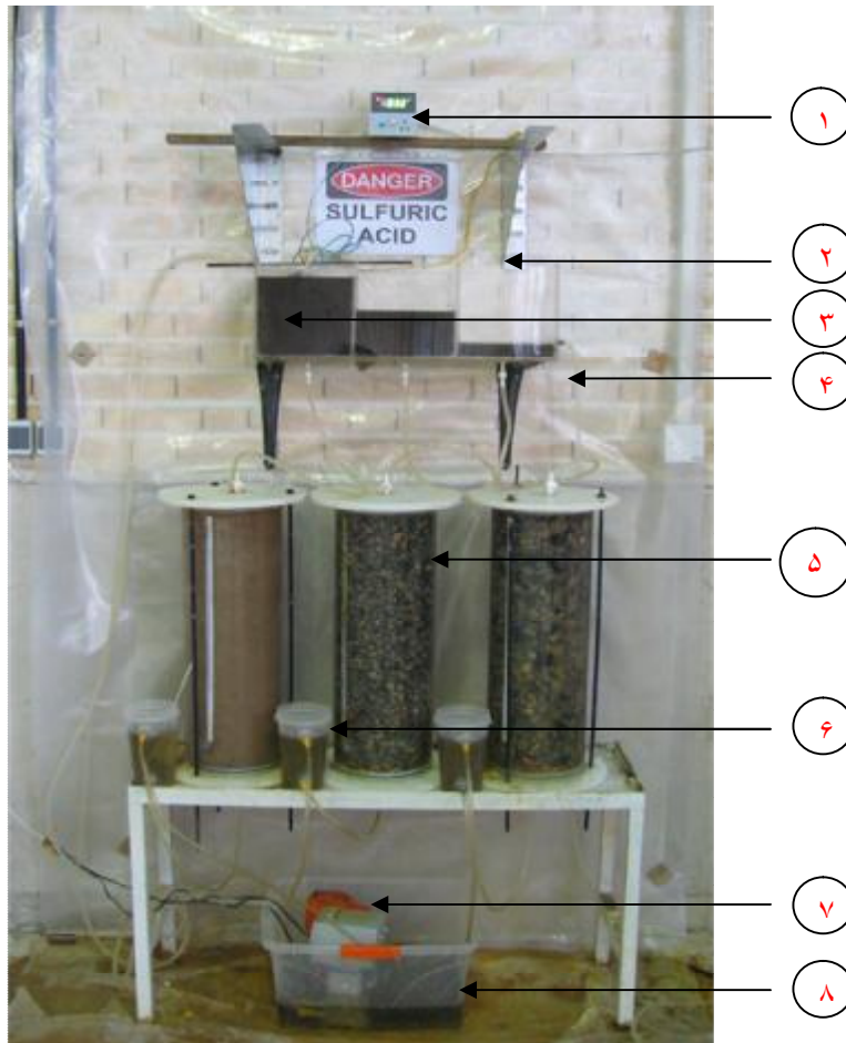
شکل 3: سیستم طراحی شده برای تعیین ضریب نفوذپذیری خاک‌ها دانه‌ای در دمای ثابت. (1) ترموکوپل (2) مخزن فوقانی برای ایجاد ارتفاع ثابت اسید (3) المنت حرارتی ضد اسید (4) لوله سرریز (5) سلول شفاف ضد اسید برای نمونه‌های شن، فیلتر و کاشین (6) مخزن تحتانی برای ایجاد ارتفاع ثابت (7) پمپ (8) مخزن ذخیره سیال باردار
