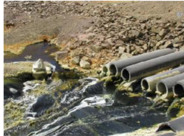
شکل 1: زهکشی سیال باردار از طریق خاک‌های دانه‌ای موجود در بستر توده‌های فروشویی (توده فروشویی 1 معدن مس سرچشمه)
