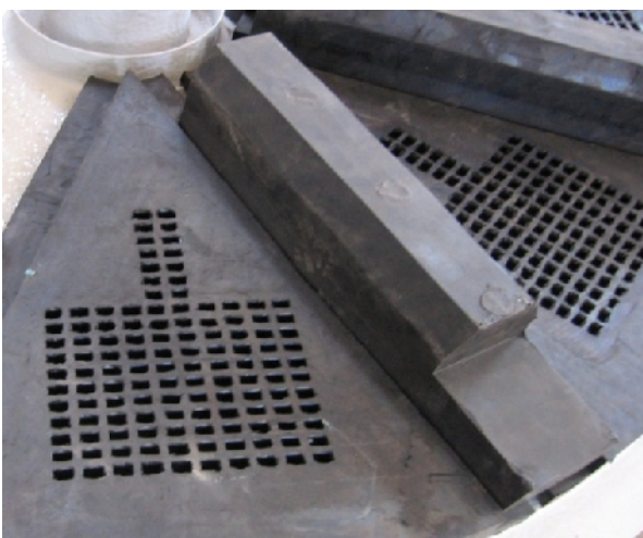
شکل ۱۰: شبکه تخلیه انتهایی آسیای گلوله‌ای واحد نیمه صنعتی مجتمع سنگ آهن گل‌گهر
