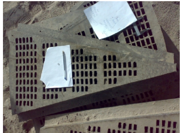
شکل ۵: قطعاتی که تشکیل‌دهنده شبکه تخلیه انتهایی در آسیای گلوله‌ای اسفوردی
