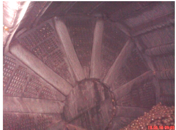
شکل ۶: شبکه تخلیه انتهایی آسیای گلوله‌ای اسفوردی
