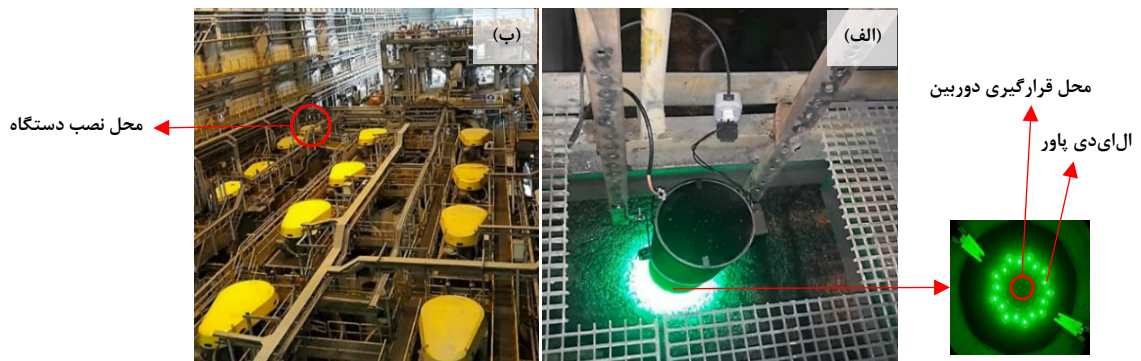
شکل ۱- نمایی از الف- دستگاه آنالیز تصویر و ب- مکان نصب آن در فاز دو معدن سونگون
