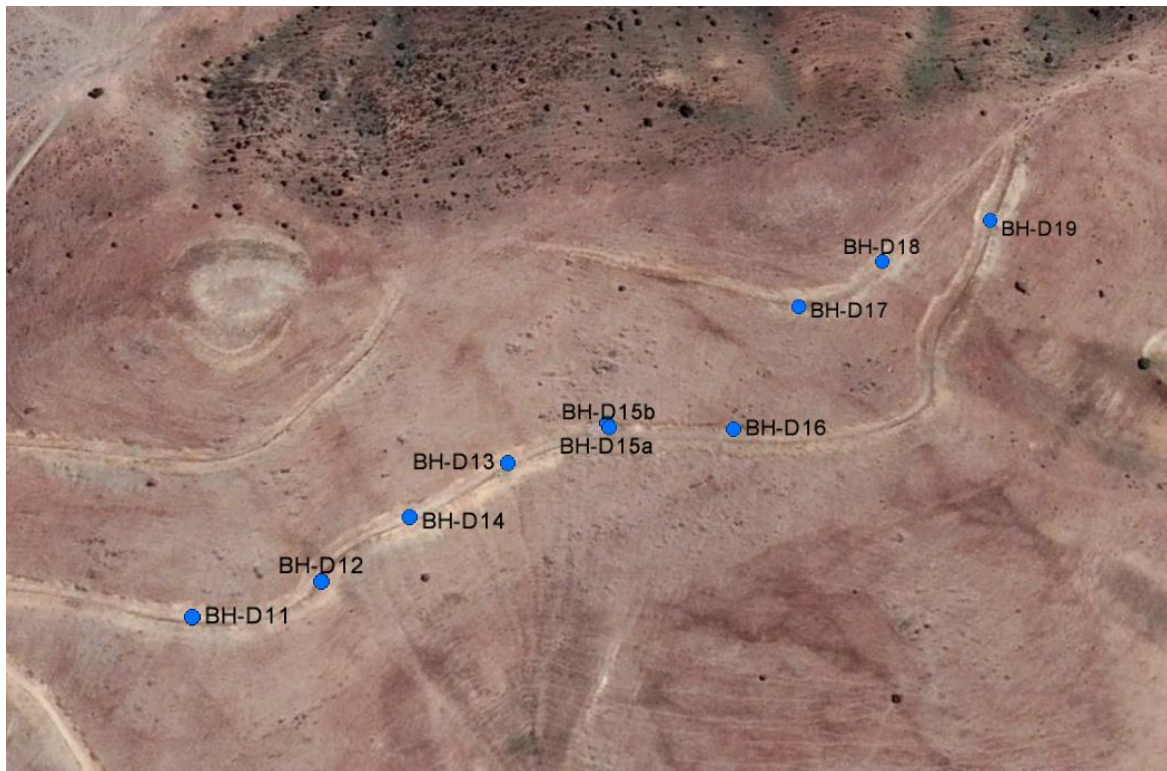
شکل ۱۳- موقعیت گمانه‌های حفر شده روی تصویر هوایی
