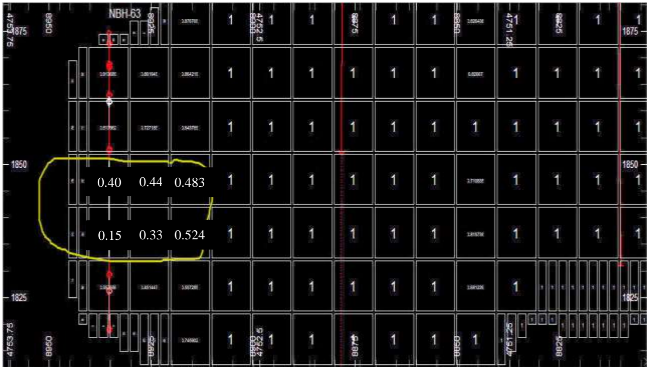
شکل ۶- نمایش یکی از مقاطع کانسار و کاهش نسبت حجمی کانسنگ در بلوک‌ها به واسطه وجود عیار کمتر از عیار حد در گمانه‌ها (محدوده با رنگ زرد مشخص شده است).
