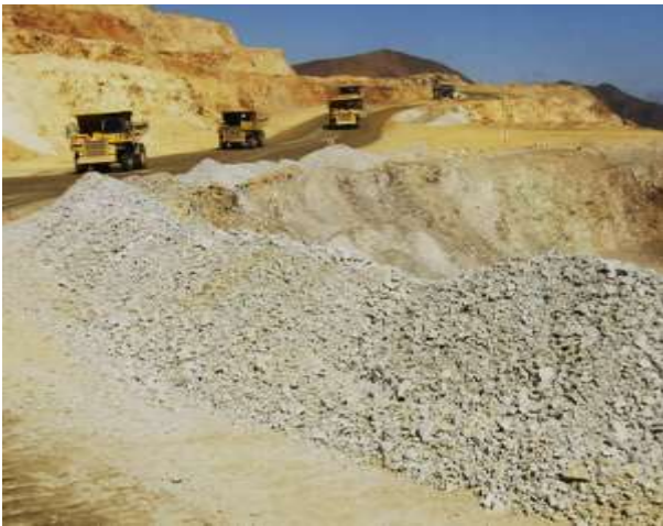
شکل ۲- نمایش ریسه ایمنی ایجاد شده با ماده معدنی در لبه پله.
