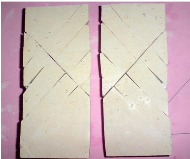
شکل ۲: نمونه دارای سه دسته ناپیوستگی متقاطع و عمود برهم شامل یک دسته قائم، دو دسته ناپیوستگی عمود بر هم هر یک دارای زاویه ۴۵ درجه و در جهت مخالف همدیگر و یک دسته با ۴ ناپیوستگی موازی
