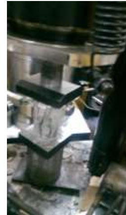
شکل ۶- لحظه شکست نمونه TB8-1 در آزمایش مقاومت فشاری تک‌محوری.
