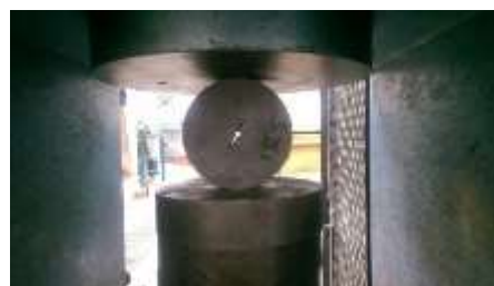
شکل ۹- قرارگیری نمونه ها با زاویه تقریباً ۲۸ درجه نسبت به جهت بارگذاری
